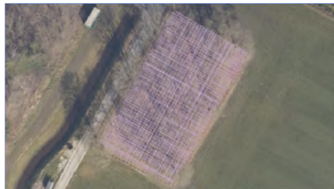
Het raster van gelopen lijnen met de grondradar. Bron: Medusa B.V.
