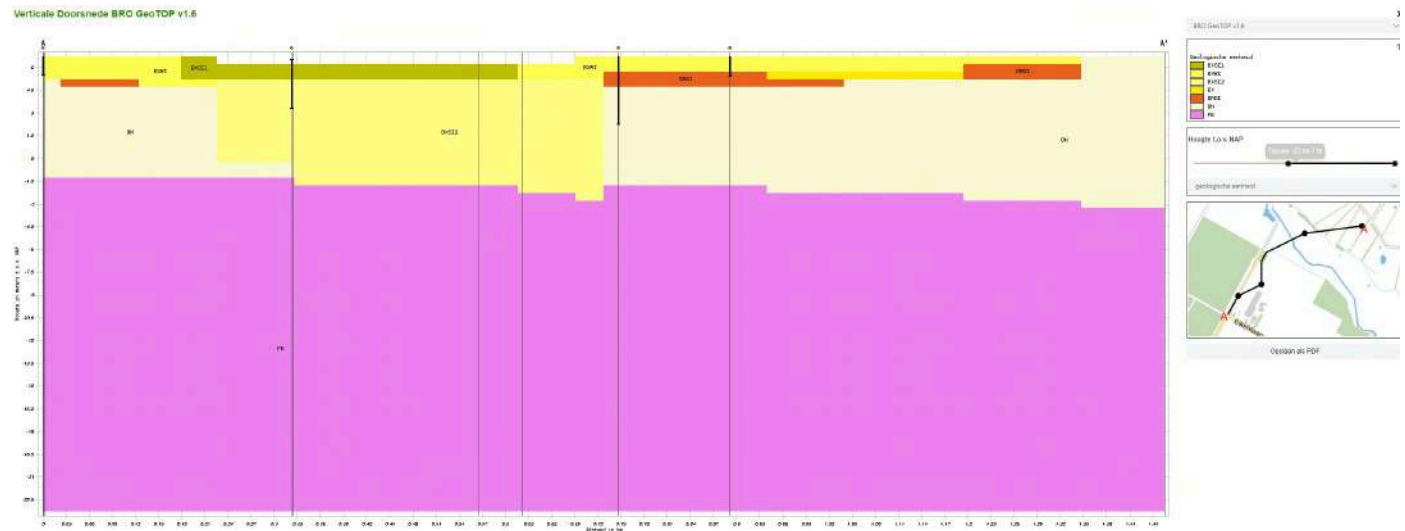
Het Dinoprofiel laat van zuid naar noord de ondergrond zien van het gebied. De Joodse Begraafplaats ligt ter hoogte van de twee verticale lijnen bij de zwarte accolade. Legenda: fel geel = dekzand, midden geel = afzettingen beekdal de Slokkert uit het Weichselien, oranje-rood = keileem uit het Saalien, licht geel = Formatie van Drachten (Midden Pleistoceen), roze = Formatie van Peelo (Elsterien). Bron: www.dinoloket.nl
