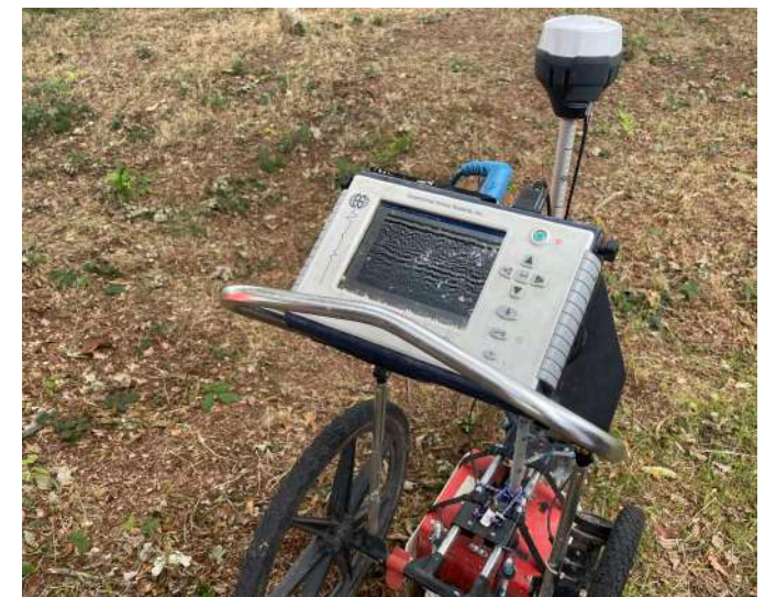
Het apparaat waarmee de grondradarmetingen worden uitgevoerd
