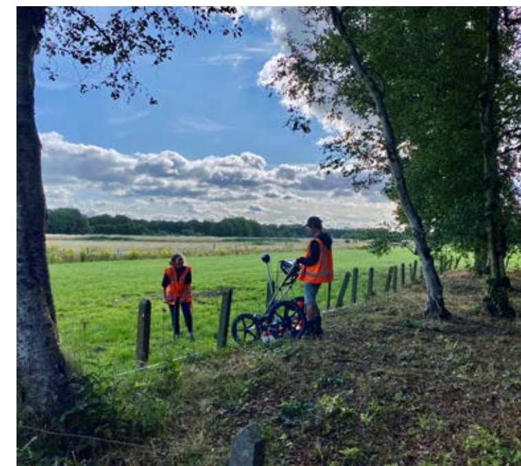
Grondradar brengt bodem in kaart
