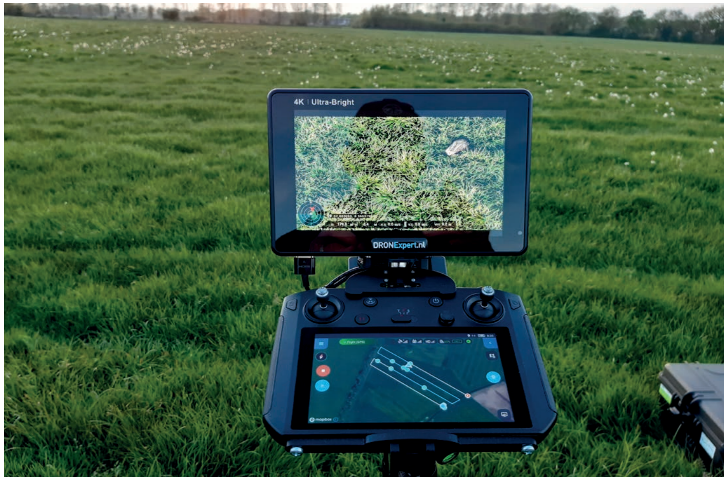
Besturingsunit van de drone (boven: beeldscherm van de camera, onder: de controller van de drone)
