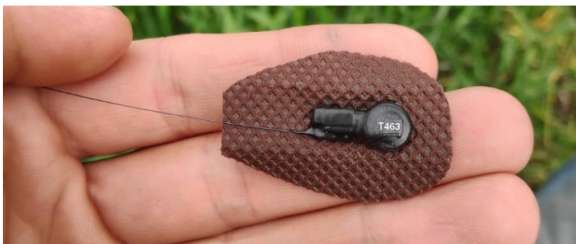
Figuur 5. Een zwart zender met een dunne antenne bevestigd op een flexibele lap kunststof.
