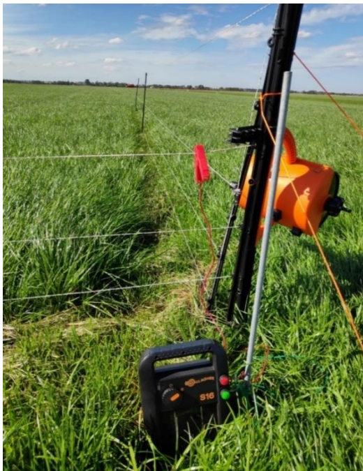
Figuur 3. Stroomraster om een Wulpennest, de accu staat gericht naar de zon en het onderliggende gras is weg gemaaid voor de gewenste spanning van 2kV.
